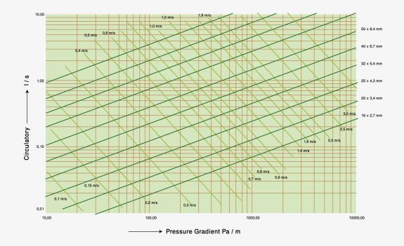
MetiTherm Pipe SDR 7.4 (PN16) Temperature: 60 °C 90 x 12,5 mm 110 x 15,2 mm 75 x 10,4 mm 1,6 m/s 0,7 m/s 50 x 6,9 mm 0,6 m/s 0,5 m/s 40 x 5,6 mm 4,0 m/s 0,4 m/s 3,0 m/s 32 x 4,5 mm 25 x 3,5 mm | / s 20 x 2,8 mm 16 x 2,2 mm 2,5 m/s Circulatory 1,8 m/s 2,0 m/s 1,4 m/s 1,2 m/s 0,8 m/s 0,9 m/s 0,2 m/s 0,3 m/s 0,01 100.00 1000.00 10000.0 → Pressure Gradient Pa / m \_\_\_\_\_
